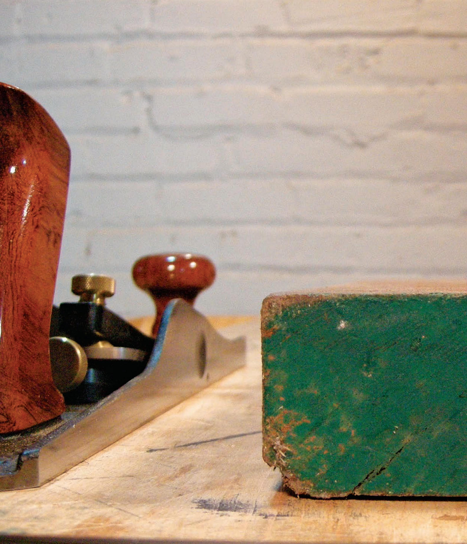
Das Rohholz wird mit der hohlen Seite nach unten auf die Hobelbank gelegt.
