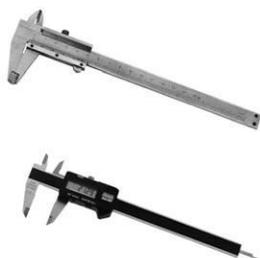
Richtiges Messen erleichtert die Arbeit und schützt vor Fehlern. Ein **Messschieber** 24 (Schieblehre) ermöglicht z. B. ein genaues Messen des Durchmessers diverser Leiter und Bauteile. Einfachere Messschieber herkömmlicher Bauart sind preiswert, aber das Ablesen des Messwertes ist hier „gewöhnungsbedürftig“. Messschieber mit Digitalanzeige zeigen das ermittelte Maß eindeutig an, sind vor allem als gelegentliche „Schnäppchen“ kostengünstig erhältlich.
