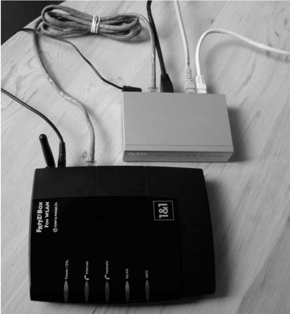
**Bild 2.11:** Vor allem bei älteren WLAN-Routern, die nach wie vor problemlos funktionieren und die man ungern durch ein teures Nachfolgemodell ersetzen möchte, lohnt sich die Erweiterung um einen externen GBit-Switch (graues Gerät). Der externe Switch wird einfach über ein (hier graues) Netzwerkkabel an einen freien LAN-Port des Routers (schwarzes Gerät) angeschlossen. Alle am GBit-Switch angeschlossenen Geräte (schwarzes, gelbes, weißes LAN-Kabel) kommunizieren mit GBit-Geschwindigkeit.
