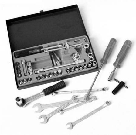
Verschiedene kleinere **Maul-, Ring- und Steckschlüssel 37** kommen in der Hauptsache bei Reparaturen an größeren Elektrogeräten zum Einsatz.
