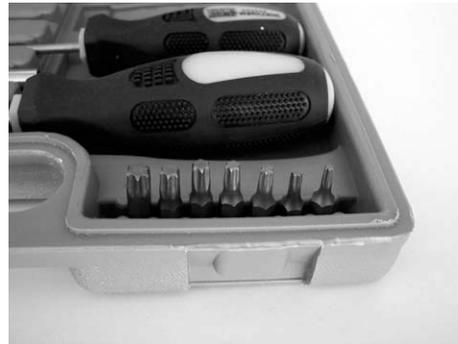
Als sehr hilfreich können sich für die Demontage diverser Haushaltsgeräte **Sechskant-Bits** **14** und **Torx-Bits** **15** erweisen, die oft als Steckschlüssel-Sets mit passenden Steckschlüsseln oder Ratschen erhältlich sind.
