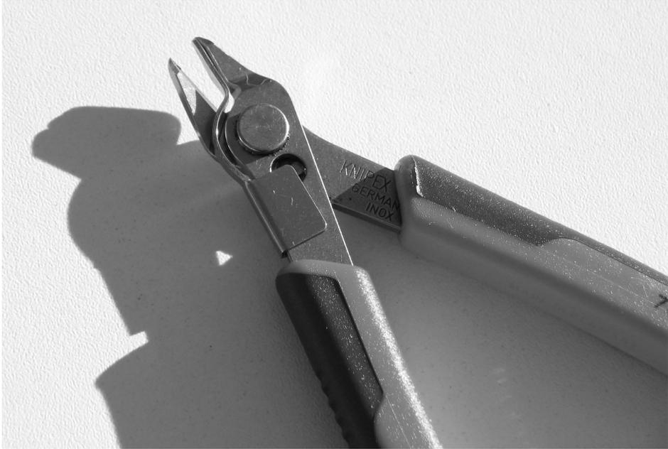
**Abb. 2.7** – Eine Printzange. Die im Bereich der Schneidefläche angebrachte Drahtklammer verhindert, dass die abgewickelten Drahtenden unkontrolliert wegspringen.
