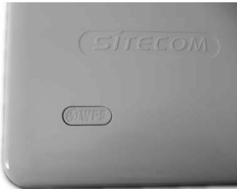
**Bild 2.23:** Aktuelle Router mit WLAN-Access-Point unterstützen WPS und besitzen eine WPS-Taste außen am Gerät.
