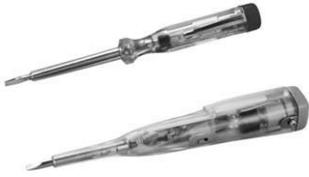
Schnelle Erkennung von elektrischer Netz-Wechselspannung ermöglichen diverse kleine **Phasenprüfer** 26 (**Spannungsprüfer**). Einfachere Phasenprüfer sind als kleine Schraubendreher ausgeführt und zeigen das Vorhandensein einer Wechselspannung (der Phase) nur optisch durch Aufleuchten eines Neonlämpchens in ihrem Griff an.
