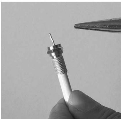
**Abb. 6:** Viele einfache Reparaturen können eigenhändig durchgeführt werden: Ein schlechter Kontakt an der Steckverbindung eines Koaxialkabels, dessen Innenleiter etwas zu dünn für die Gerätebuchse ist und zu locker in der Buchse sitzt, kann durch leichtes Zubiegen oder Verzinnen des Leiterendes in Handumdrehen behoben werden.
