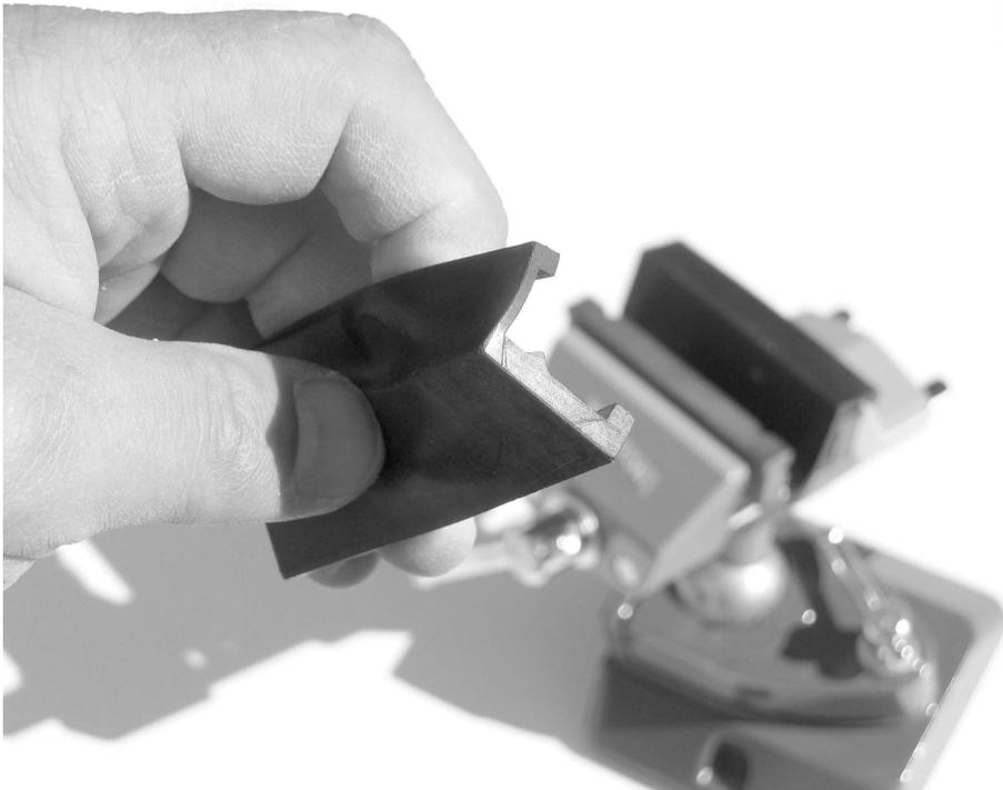
**Abb. 2.17** – Schutzkappen aus Kunststoff lassen sich über die Metallbacken des Schraubstocks stülpen und schützen so empfindliche Werkstücke.
