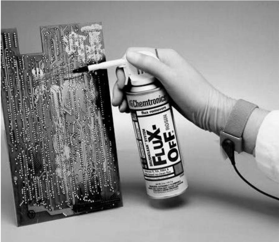
**Abb. 2.20** – Mit einem Flussmittelspray lassen sich Lötückstände bequem entfernen. Wischen Sie mit einem Tuch nach. (Foto: Chemtronics)
