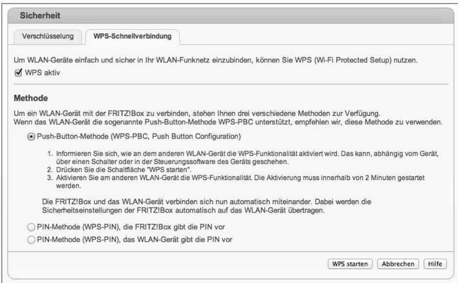
**Bild 2.25:** In diesem WPS-fähigen Router (FRITZ!Box 7390) kann zwischen der *Push-Button-Methode* und der *PIN-Methode* gewählt werden.
