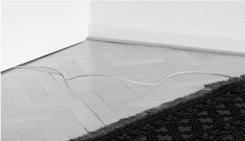
**Bild 2.28:** Derart »verlegte« Netzkabel stellen ein Sicherheitsrisiko dar.
