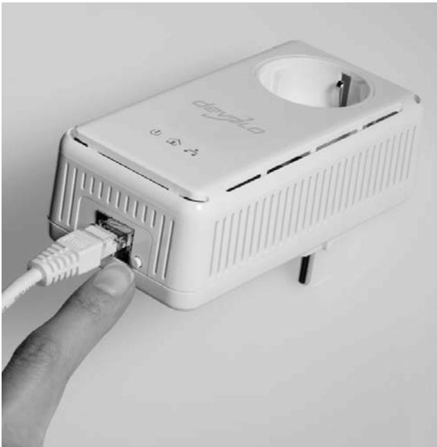
**Bild 2.32:** Drücken Sie dieses Knöpfchen zunächst zehn Sekunden. Dazu muss der Adapter – anders als in dieser Abbildung – jedoch in einer Steckdose eingesteckt sein. (Quelle: [www.devolo.de](http://www.devolo.de))
