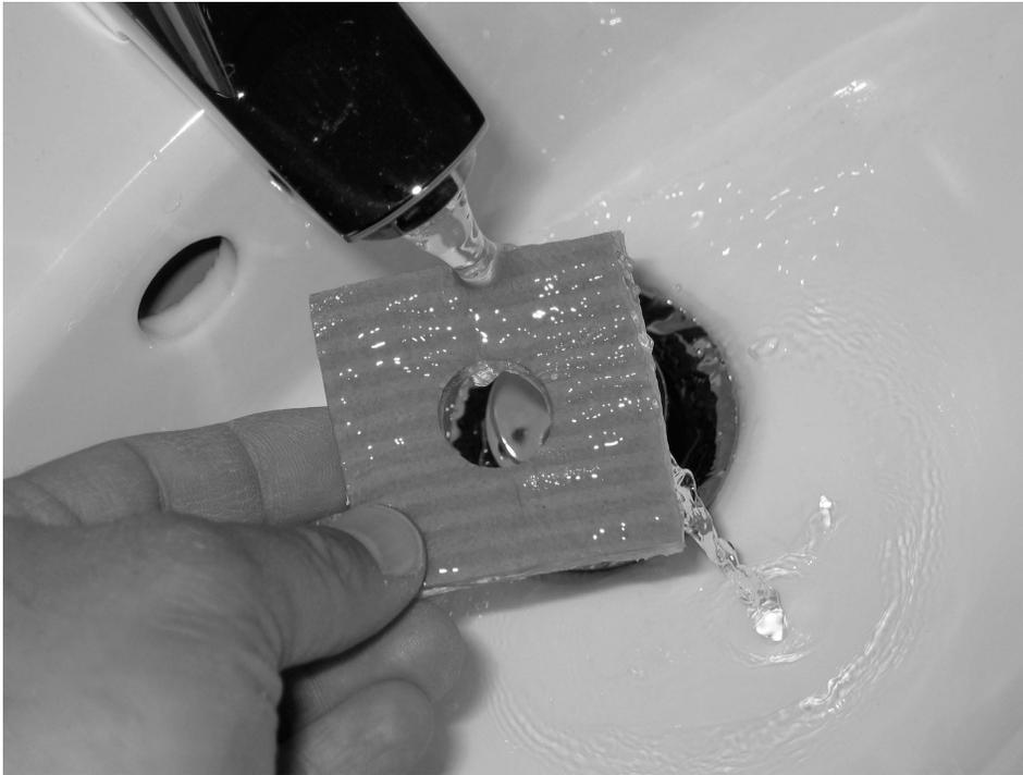
**Abb. 2.12** – Den Lötswamm kann man unter fließendem Wasser befeuchten, ausdrücken und in die Schale des LötKolbenständers legen.
