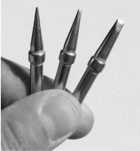
**Abb. 2.3** – Drei unterschiedliche Lötspitzen, links im Bild eine Bleistiftspitze.
