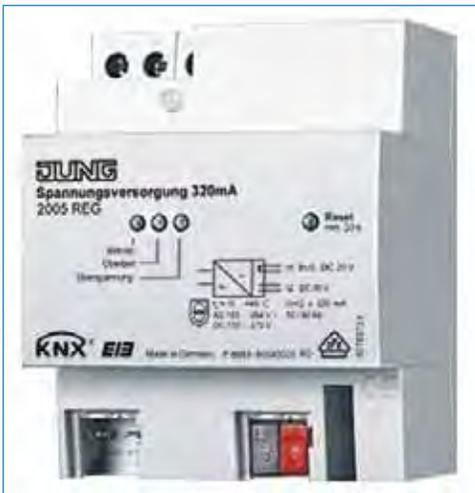
Abb. 1.47: Für die Spannungsversorgung der Displays, aller Bedienungsgeräte, aller Aktoren und weiterer KNX-Komponenten ist ein gemeinsames KNX-Netzgerät zuständig. Es ist für unterschiedlich große Leistungen erhältlich. (Foto: Jung GmbH)
