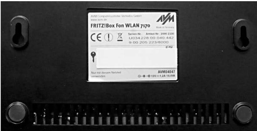
**Bild 2.26:** Die SSID (hier: FRITZ!Box Fon WLAN 7170) und der WPA-Schlüssel (hier: 81...) sind bei vorverschlüsselten WLAN-Routern meist auf der Geräteunterseite abgedruckt.
