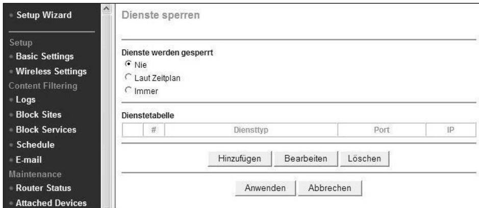
**Bild 1.5:** Die *Dienstetabelle* listet bei Routern aus dem Hause Netgear alle Dienste auf, die gegenwärtig gesperrt werden. Sie können Dienste dieser Tabelle hinzufügen oder sie auch daraus löschen.
