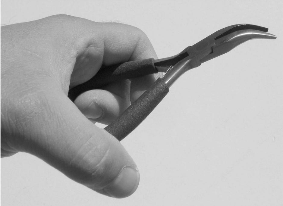
Abb. 2.5 – Gebogene Elektronikerflachzange
