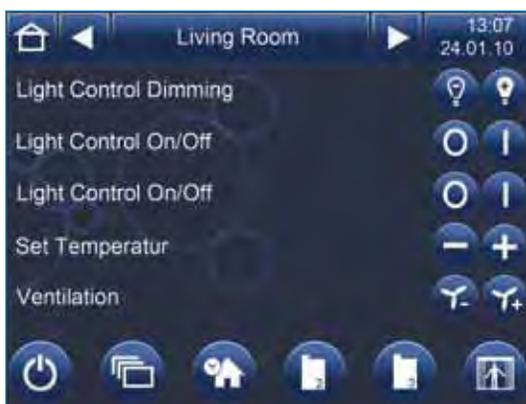
**Abb. 1.25:** Das KNX-Anzeige/Bedienungsdisplay ETS6C von IPAS GmbH stellt bis zu 64 Szenen zur Verfügung, die leicht konfigurierbar sind.
