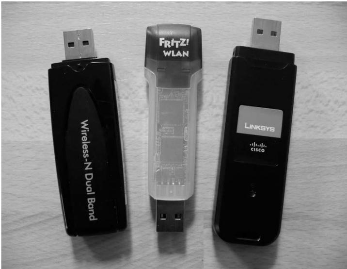
**Bild 2.22:** Dualband-USB-Adapter (hier: Netgear, AVM, Cisco/Linksys) können wahlweise Verbindungen mit 2,4- oder 5-GHz-Access-Points eingehen.
