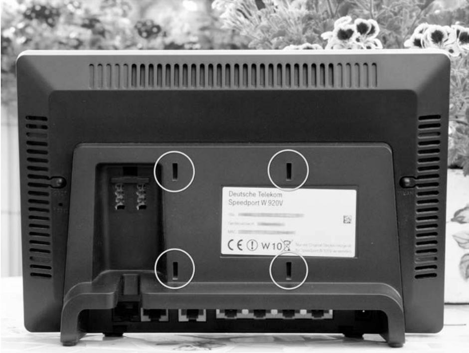
**Bild 2.17:** Selbst ältere Routermodelle wie dieser Speedport waren bereits mit Aussparungen zur Wandbefestigung versehen (siehe Markierungen).
