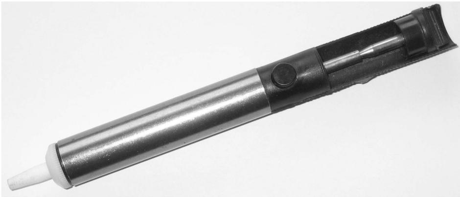
**Abb. 2.24** – Eine höherwertige Entlötpumpe ist oft an einem Metallzylinder erkennbar.
