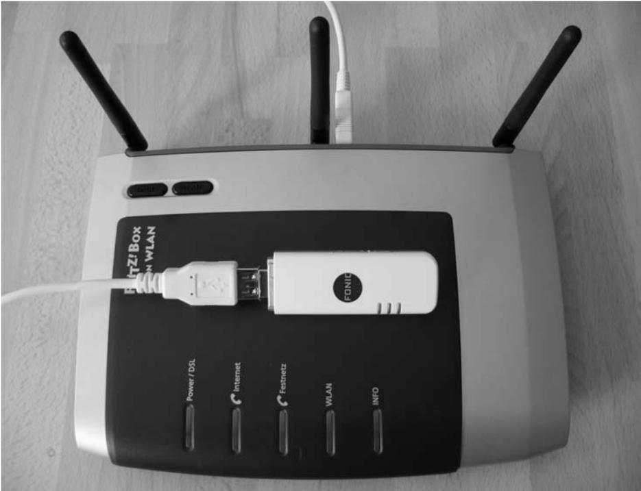
**Bild 1.13:** Manche Heimnetzrouter mit USB-Schnittstelle, wie diese FRITZ!Box 7270 von AVM, können eine Onlineverbindung zur Not auch per UMTS bereitstellen.
