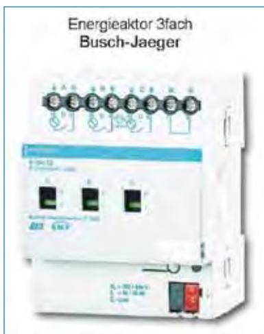
**Abb. 1.41:** Ausführungs- und Anschlussbeispiel eines »Energieaktors 3-fach«, an dem drei unabhängige Lichtsektionen mit einem Laststrom von bis zu 20 A angeschlossen werden können. Am Aktorgehäuse befinden sich zusätzliche Schalter, die ein manuelles Ein- und Ausschalten einzelner Sektionen ermöglichen. (Foto: Busch-Jaeger)
