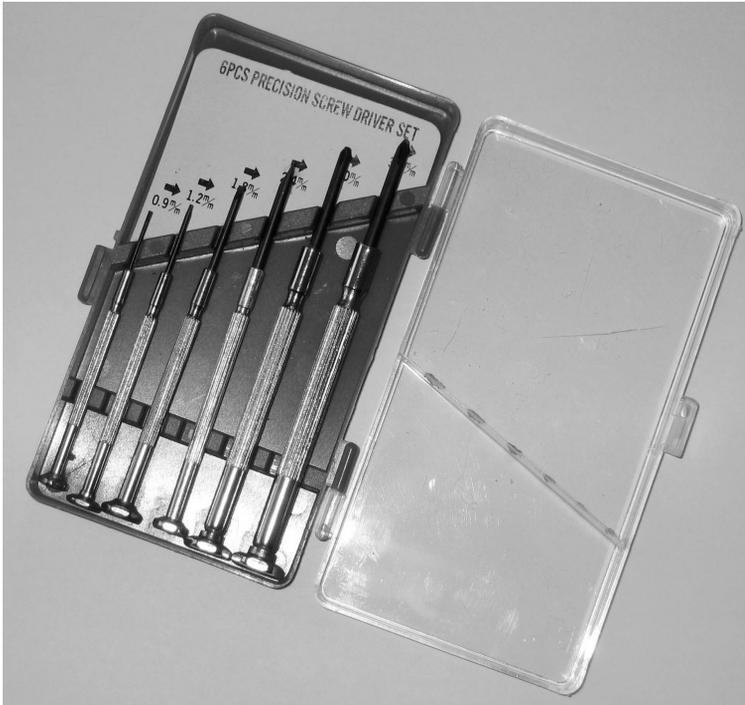
Abb. 2.10 – Feinmechaniker-Schraubendreher im Set.
