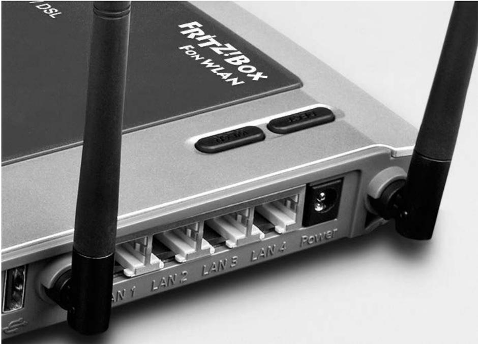
**Bild 2.6:** Der Switch (LAN 1 bis LAN 4) befindet sich immer an der Rückseite des Heimnetzrouters. (Quelle: [www.avm.de](http://www.avm.de))
