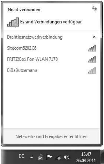
**Bild 2.27:** Unter der Überschrift *Drahtlosnetzwerkverbindung* listet das Verbindungstool von Windows alle verfügbaren WLANs oder Access Points in der Umgebung auf.
