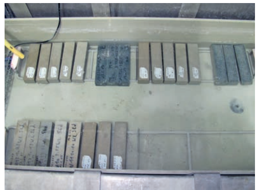
Bild 1.6: Normgemäße Lagerung der entschlackten Probekörper im Wasserbad (3. bis 7. Tag)
