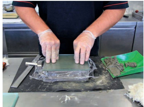
Bild 1.4: Durch Auflegen einer Glasplatte wird der Mörtel vor dem Austrocknen geschützt.
