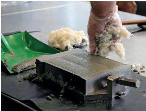
Bild 1.3: Der Rand der Form wird mit Putzwolle gereinigt.
