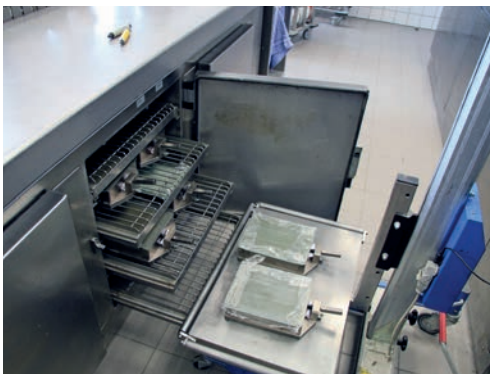
Bild 1.5: Anschließend wird die Stahlform für zwei Tage in die Klimakammer gelagert.
