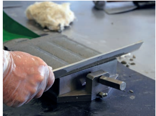
Bild 1.2: Überschüssiger Mörtel wird nach dem Befüllen der Form abgezogen.
