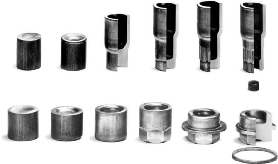
Abb. 1.13 Verfahrenfolgen beim Fließpressen, Beispiele Hatebur AG
