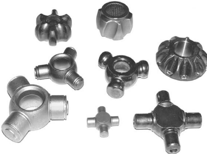
Abb. 1.10 Durch Querfließpressen hergestellte Werkstücke. Bild: ThyssenKruppPresta
