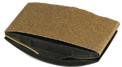
Abb. 1–28 Der fertig vorbereitete Schleifblock
