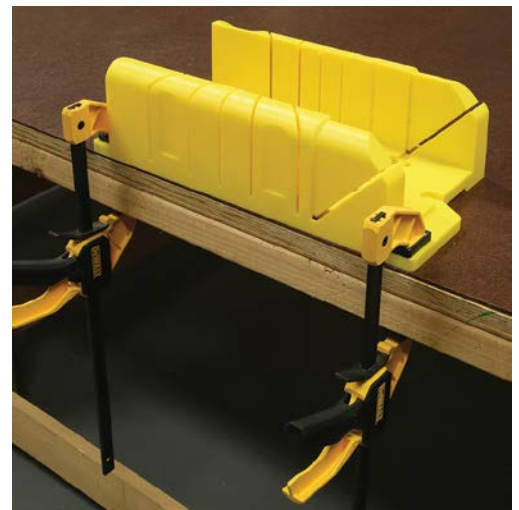
Abb. 1–8 Die Gehrlade sollte die Möglichkeit bieten, sie an Ort und Stelle festzuklemmen.
