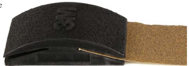
Abb. 1–26 Führen Sie einen 7 cm breiten Streifen Schleifpapier an einem Ende in den Schleifblock ein, wobei Sie die Nut nach oben drücken, damit sich das Schleifpapier in die Öffnung schieben lässt.
