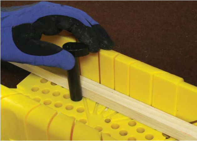
Abb. 1-10 Manche Gehrladen haben als Zubehör Exzenter, mit denen sich das Holz in der jeweiligen Position arretieren lässt.
