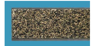
Abb. 1–14 Korkbeschichtung auf der Rückseite eines Edelstahllineals
