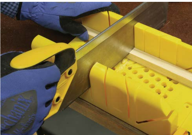
Abb. 1-12 Holz mit einer Gehrlade sägen
