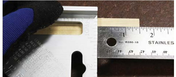
Abb. 1–19 Den Abschnitt der Holzleiste messen, die Sie absägen wollen
