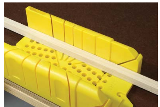
Abb. 1–9 Eine Vierkanteleiste in der Gehrlade platzieren
