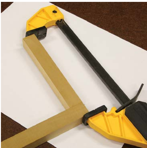
Abb. 1–31 Die Festigkeit von Leim mit einer Zwinge prüfen
