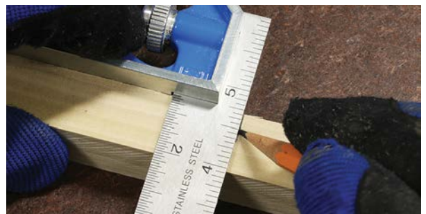
Abb. 1–22 Eine 90-Grad-Markierung mit einem Kombinationswinkel ziehen
