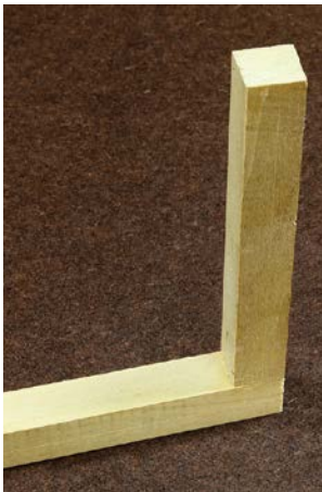
Abb. 1–30 Die Festigkeit von Leim ohne Zwinge prüfen
