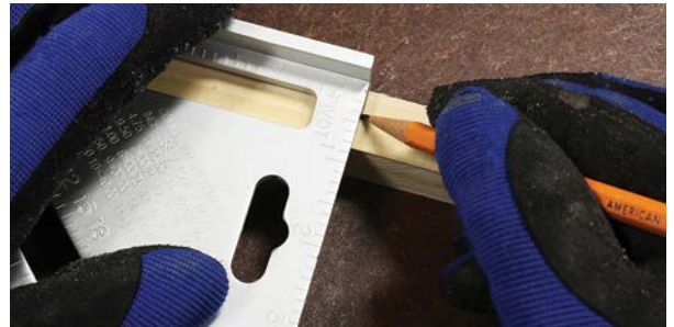
Abb. 1–20 Die Linie zeichnen, an der Sie sich beim Sägen orientieren
