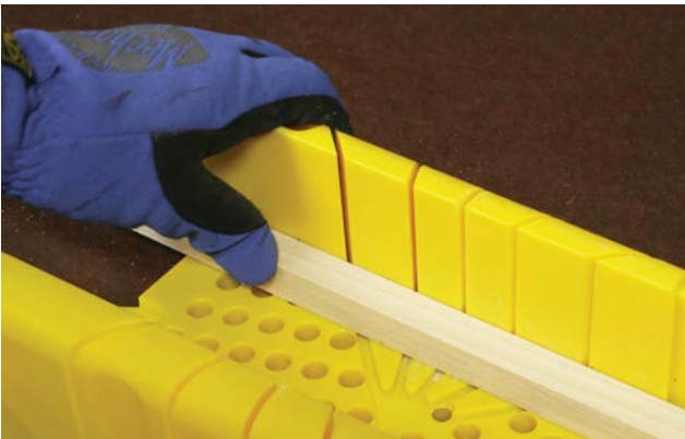
Abb. 1-11 Das Holz fest an die hintere Seite der Gehrlade drücken
