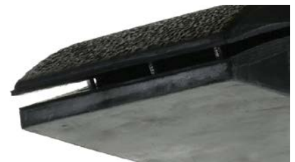
Abb. 1–27 Die Nadeln im Schleifblock halten das Schleifpapier zurück.
