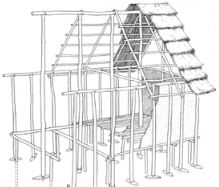
Abb. 1.3: Rekonstruktion eines jungsteinzeitlichen Pfahlhauses nach den Ausgrabungsergebnissen von Hornstaad am Untersee (Bodensee): Die Konstruktion gründet sich auf tief gehende Pfählungen und auf Ständer, die zur besseren Lastverteilung in Pfahlschuhe eingezapft sind. (Quelle: Schlichtherle, 1997, S. 60)
