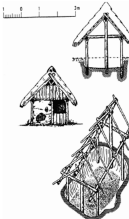
Abb. 1.7: Grubenhaus in Pfostenbauweise, Grabungsbefund mit Rekonstruktion von Gladbach, Kreis Neuwied, 7./8. Jahrhundert n. Chr. (Quelle: Gromer, 2000, S. 28)
