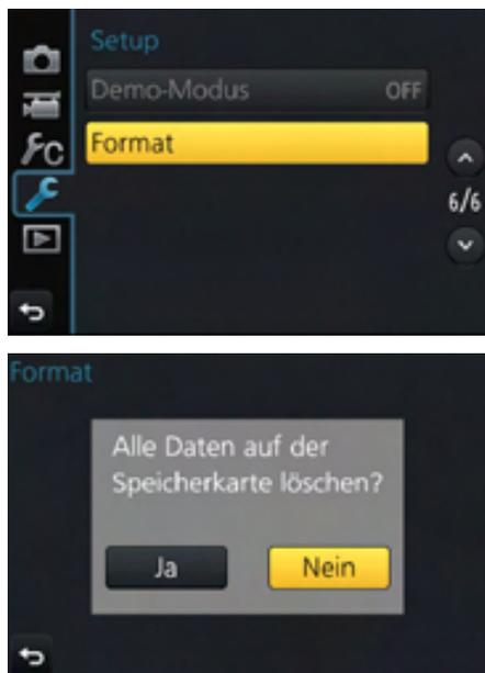
► Im Menü **Setup 6/6** können Sie mit dem Befehl **Format** die Speicherkarte formatieren. Bestätigen Sie die Abfrage mit **Ja (SET)**.
