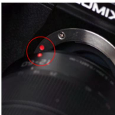
► Richten Sie die Markierungen zur Objektivpositionierung aus, um das Objektiv passgenau an das Bajonett zu setzen und es wieder abzunehmen.
