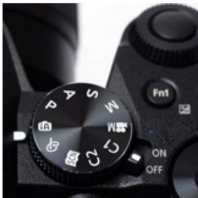
◀ Mit dem rechten Moduswahlrad werden unter anderem die verschiedenen Belichtungsmodi, die Szenenauswahl sowie Effektfilter und der manuelle Videomodus direkt ausgewählt.
